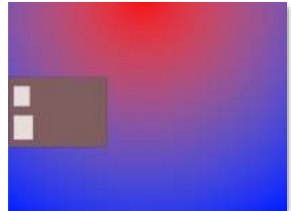
Figure 7 diffusion du son dans la pièce par rapport à l'emplacement de la climatisation
